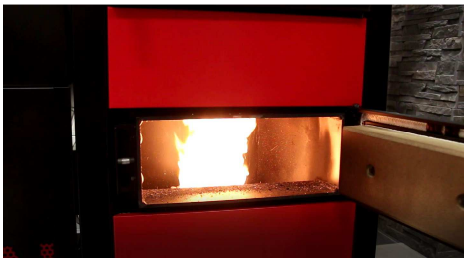
Obr. č. 33 – Optimální tvar plamene
