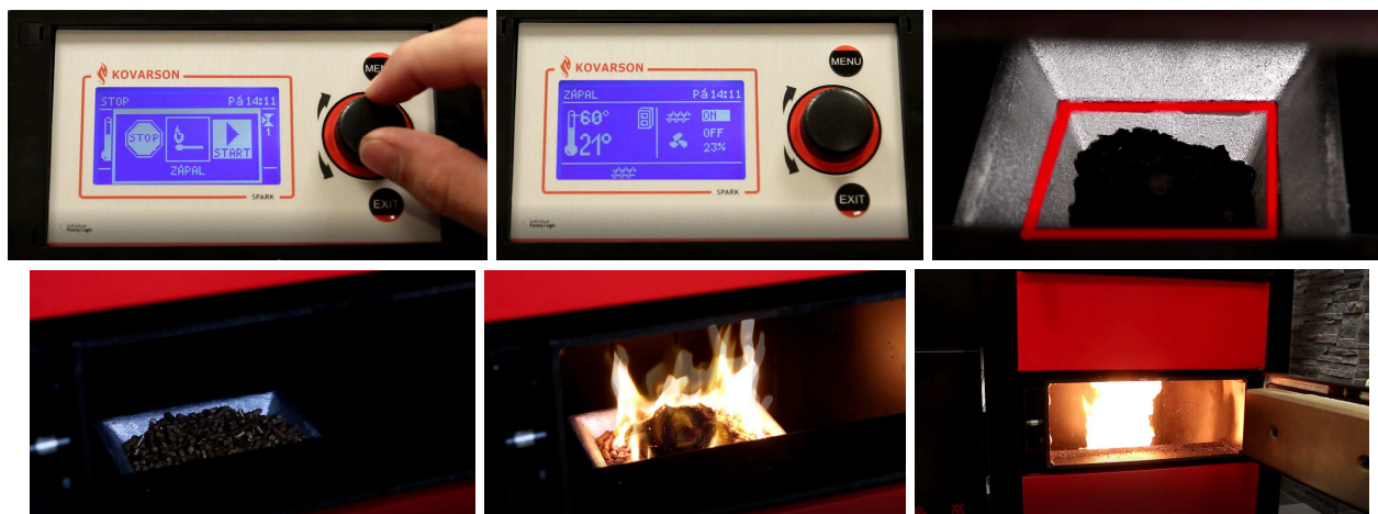
Obr. č. 32 – postup zapálení kotle
