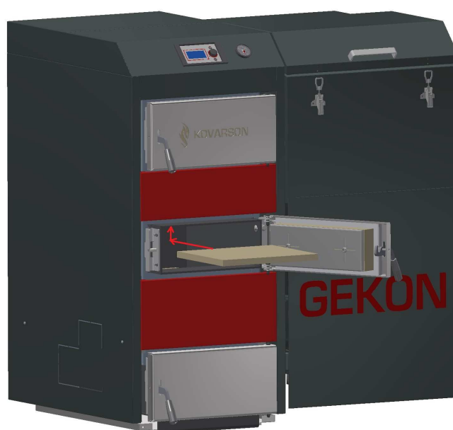
Obr. č. 19 - Vložení šamotové desky nad hořák
